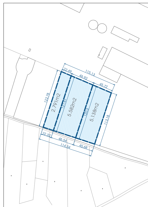
SUELO INDUSTRIAL P4-P 5.138 m 2 SUELO INDUSTRIAL P4-B 5.582 m 2 SUELO INDUSTRIAL P4-C 2.791 m 2
